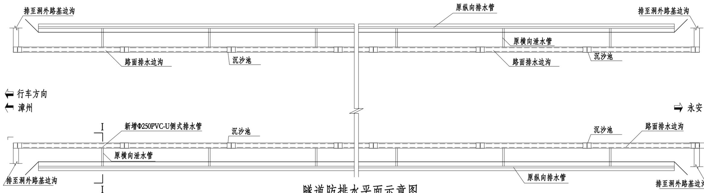
隧道防排水水平面示意图
