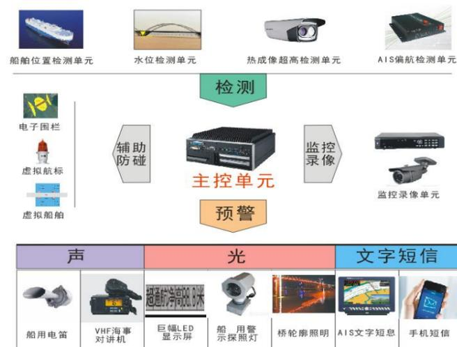
系统主要功能有：气象水文监测、偏航船舶监测预警、船舶超高预警、桥区事故取证、数据查询及大数据统计、应急联动等六大主要功能。
